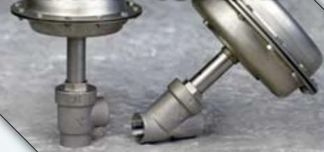
**S**ono valvole con corpo in acciaio inox AISI 316, aventi un servocomando modulante sono disponibili dal DN 15 al DN 65 nei vari segnali di comando: 3÷15, 6÷18, 6÷30 psi. Possono operare ad una temperatura massima di 190°C e sono fornibili con una svariata serie di connessioni. Sono caratterizzate da ingombri ridotti che ne permettono l'installazione anche dove vi sono problemi di spazio.
