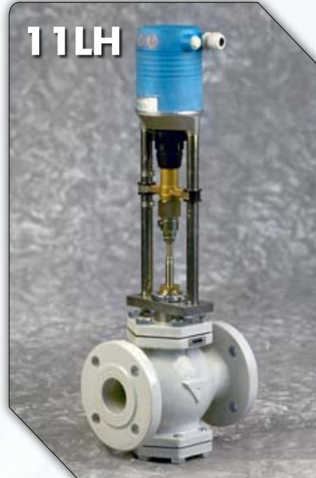
Attuatore elettrico tipo "LH" a movimento lineare, segnali di input e output reversibili indipendentemente; segnale di input regolabile liberamente: 3 punti o modulante; grado di protezione IP54.
