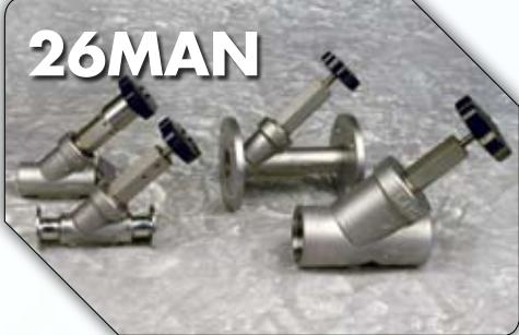
**Valvole manuali con corpo a flusso libero,** disponibili dal DN 15 al DN 65, con attacchi filettati GAS femmina, a saldare di tasca, filettati NPT, flangiati foratura UNI PN 16, flangiati ridotti.
