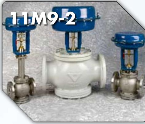
Valvole pneumatiche a due vie di regolazione, disponibili dal DN 15 al DN 200, con corpo in ghisa sferoidale o corpo AISI316, azionate da servocomando a membrana tipo: SS0(Ø205), SS1(Ø275), SS3(Ø360), SS2(Ø430), SS2L(Ø430 lungo), SS4(Ø430 doppio). Per ulteriori informazioni consultare il catalogo 11M9-2.
