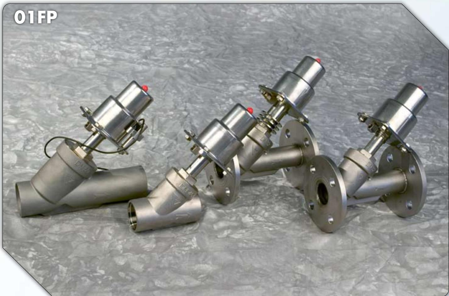
**Valvole pneumatiche a due vie di intercettazione tipo on-off a flusso libero (45°), disponibili nei funzionamenti normalmente chiuso, normalmente aperto o a doppio effetto, dal DN 15 al DN 65, con servocomando in acciaio inox AISI 304, e temperatura massima di utilizzo 190°C.**
