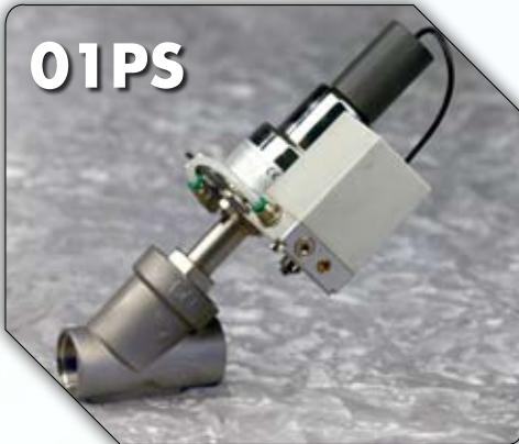
Le valvole pneumatiche proporzionali con controllo di posizione da trasduttore lineare a due vie a flusso libero (45°), sono disponibili dal DN15 al DN65 con attacchi filettati GAS femmina, a saldare di tasca, filettati NPT, flangiati foratura UNI PN16 (spessore ridotto). Corpo in AISI 316 e servocomando in AISI 304, temperatura massima d'esercizio 190°C. Per ulteriori informazioni consultare il catalogo 01 PS.
