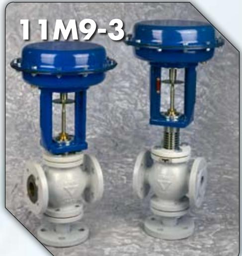
Valvole pneumatiche a tre vie di regolazione, disponibili dal DN 15 al DN 200, con corpo in ghisa sferoidale o corpo AISI316, azionate da servocomando a membrana tipo: SS0(Ø205), SS1(Ø275), SS3(Ø360), SS2(Ø430), SS2L(Ø430 lungo), SS4(Ø430 doppio).
