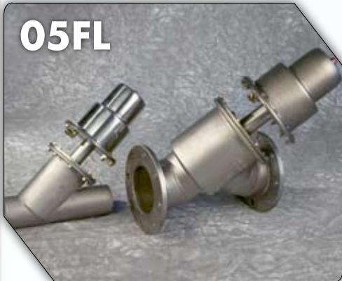
**Valvole pneumatiche a due vie di intercettazione tipo on-off a flusso libero (45°), disponibili nei funzionamenti normalmente chiuso, normalmente aperto o a doppio effetto, dal DN 80 al DN 150, con attacchi a saldare di testa, flangiati con foratura UNI PN 16, flangiati ridotti. Corpo in acciaio inox AISI 316 e servocomando in acciaio inox AISI 304, temperatura massima di impiego 150°C. Per ulteriori informazioni consultare il catalogo 05FL.**
