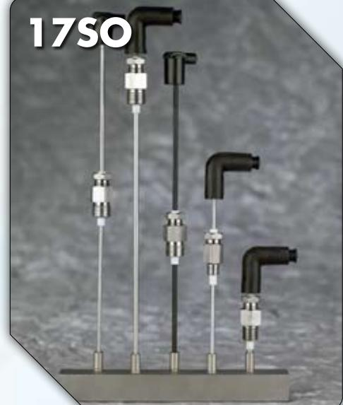
Sonde di livello conducimetriche in acciaio inox AISI 316, con attacchi standard da 1/2" GAS (filettati maschio), guaine in PTFE (temperatura massima di utilizzo 160°C), o in PVC (temperatura massima di impiego 90°C).
