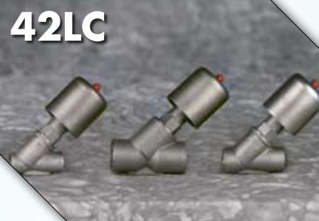
**Valvole pneumatiche a due vie di intercettazione tipo on-off a flusso libero (45°), disponibili nel funzionamento normalmente chiuso dal DN 15 al DN 25, corpo in AISI 316 filettato gas femmina, e servocomando in AISI 304; ha dimensioni compatte ed opera normalmente a temperature da -10°C fino a +180°C. Per ulteriori informazioni consultare il catalogo 42 LC.**
