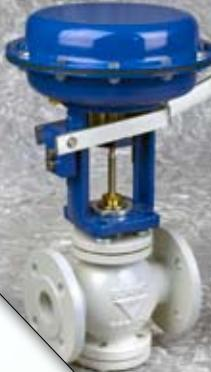
**V**alvola di scarico ad azionamento pneumatico e manuale o solo manuale, disponibile dal DN 15 al DN 65, con corpo in ghisa sferoidale GGG40.3 o AISI316, temperatura fino a 300°C. Per ulteriori informazioni consultare il catalogo 11BD.
