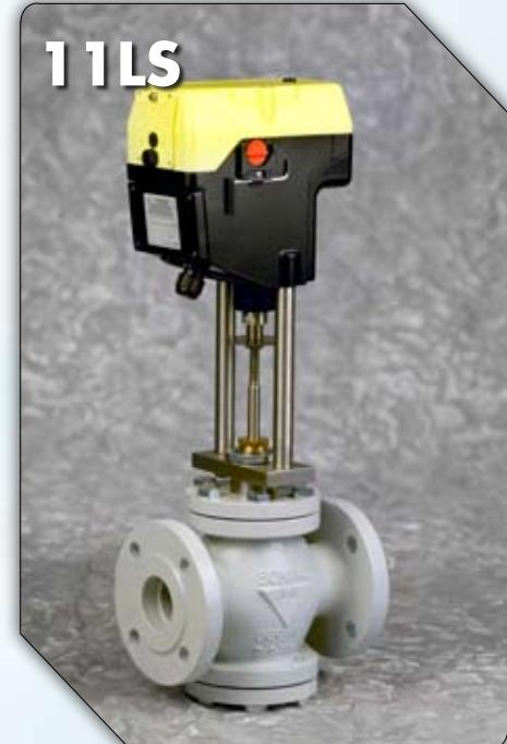
Attuatore elettrico tipo "LS" a movimento lineare, con auto-adattamento dell'alimentazione 24 ... 230VAC/DC; segnale di input: 3 punti o modulante; custodia in alluminio IP66.
