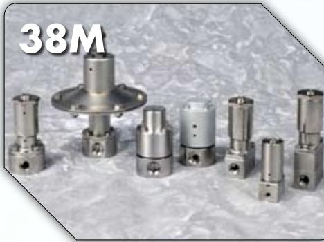
**Valvole pneumatiche per flussi ridotti on-off a due vie serie "MA" e serie "MN" ed a tre vie serie "MNT". Sono caratterizzate da ingombri ridottissimi per l'utilizzo in impianti con problemi di spazio.** **Serie "MA"**: con corpo in acciaio inox AISI 316, disponibile DN 5 o DN 8 entrambe con attacchi filettati GAS femmina e con servocomando in alluminio o acciaio inox AISI 304; temperatura massima di utilizzo 150/160 °C.
